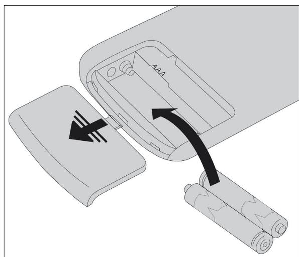
**SI EL MANDO A DISTANCIA ESTÁ APAGADO POR AUSENCIA DE BATERÍAS, ES POSIBLE CONTROLAR LA ESTUFA DESDE EL PANEL DE MANDOS, PUESTO EN LA PARTE SUPERIOR DE LA ESTUFA. DURANTE LA OPERACIÓN DE SUSTITUCIÓN PRESTE ATENCIÓN A LAS POLARIDADES SIGUIENDO LA SIMBOLOGÍA IMPRESA EN EL COMPARTIMENTO INTERNO DEL MANDO A DISTANCIA.**
